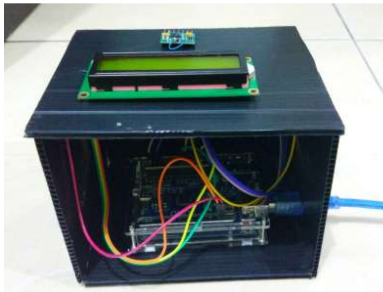
Gambar 4.4 Alat ukur saturasi oksigen berbasis Arduino
